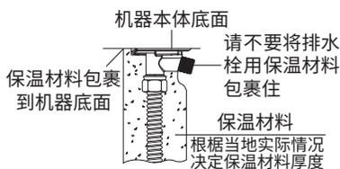
注：在寒冷地区，建议在配管上先进行电加热防冻设置后再包裹保温材料。
